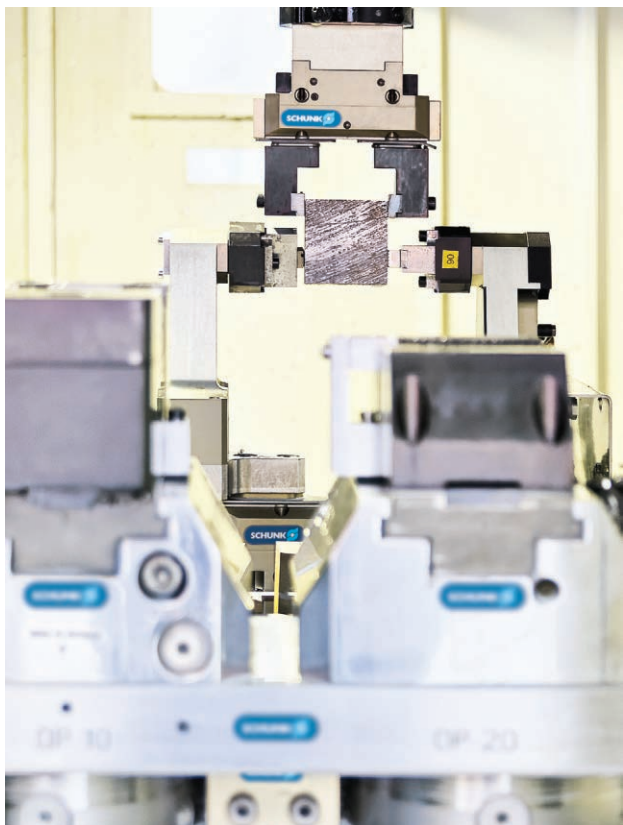
图2 装载时，Schunk 通用夹具通过传统刀架固定在机床主轴上，然后移动到工件库，同时拾取一个水刀切割毛坯，然后将其放入夹紧块中
