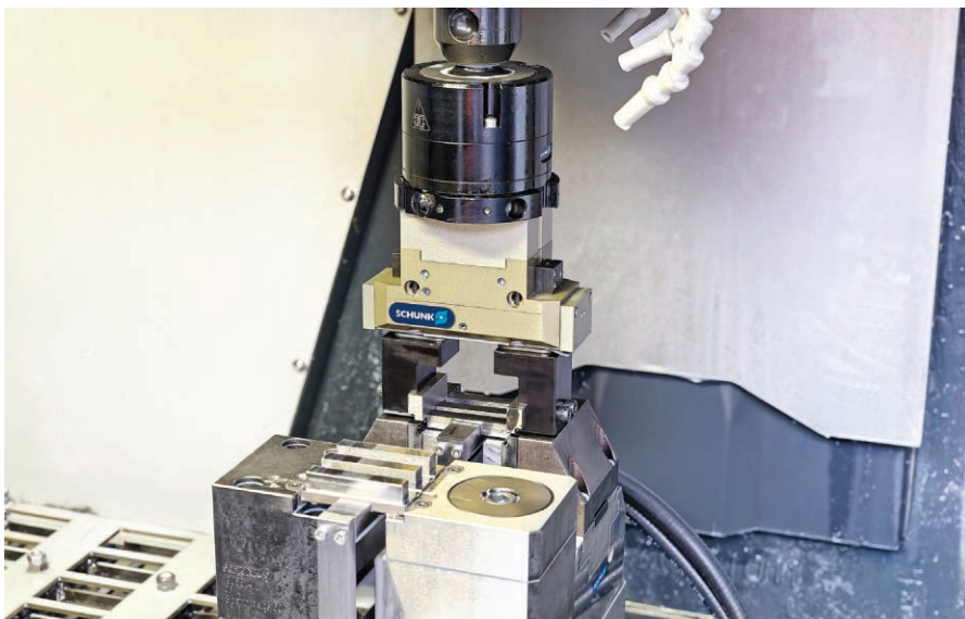
图3 在完成最后一个加工操作后，三个样品被分开，然后一起打包，再被夹具取走送至工件库指定的位置
