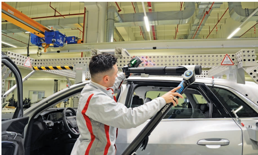
图 2 汽车内外部件灵活检测
