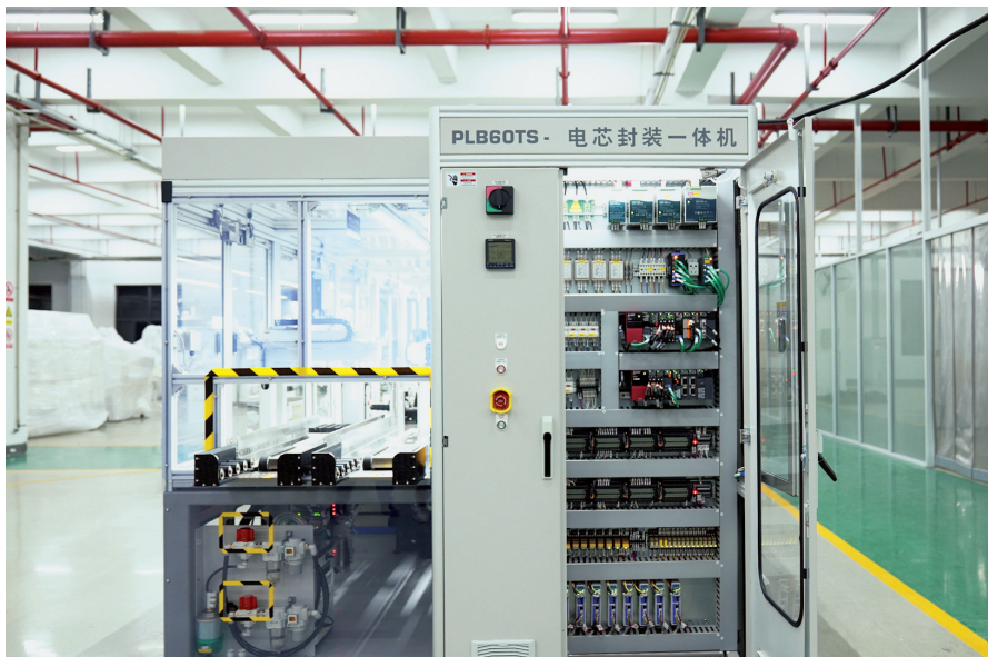
图 2 三菱电机全新 R 系列可编程控制器实现了三屹晨光新型生产线对高精度运动控制的要求
