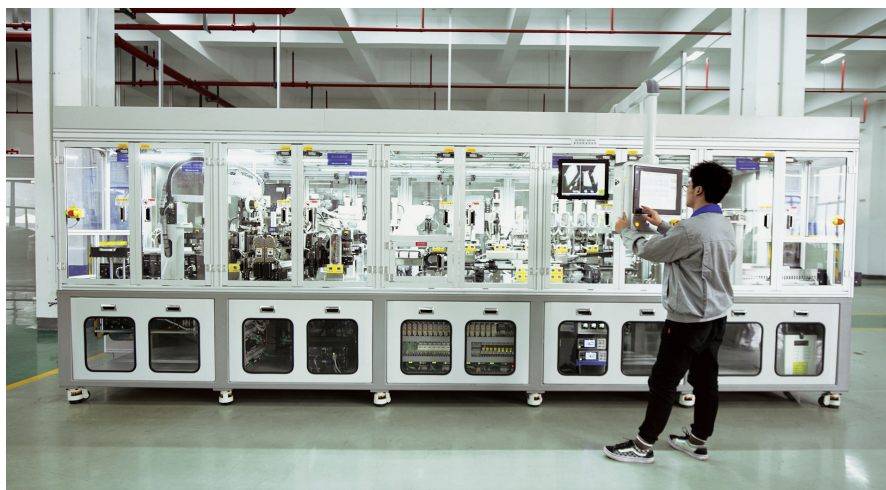
图1 新型锂电池封装生产线采用全自动直线式的结构，便于与各工序设备连机或成为独立设备，在90%的工位实现了一键换型
