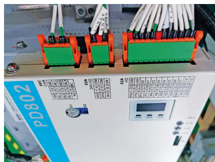
菲尼克斯电气为汇川技术提供了创新双层高密度 Push-in 直插自锁技术的 DFMC/DMC 1,5 系列连接器
