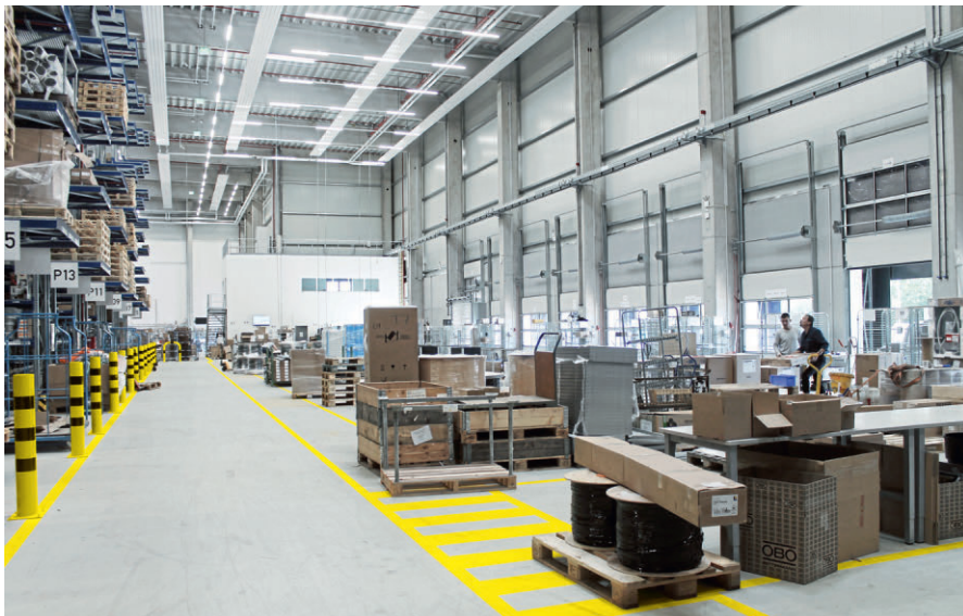
图 2 物资出库的拣选配货区直接挨着进货区，拣选配货单以最优化的方式发送到各个拣选配货工位。物资发货区也直接毗邻拣选配货区，因此大型的物资就可以直接运送到靠近库门的出库物资集结区
