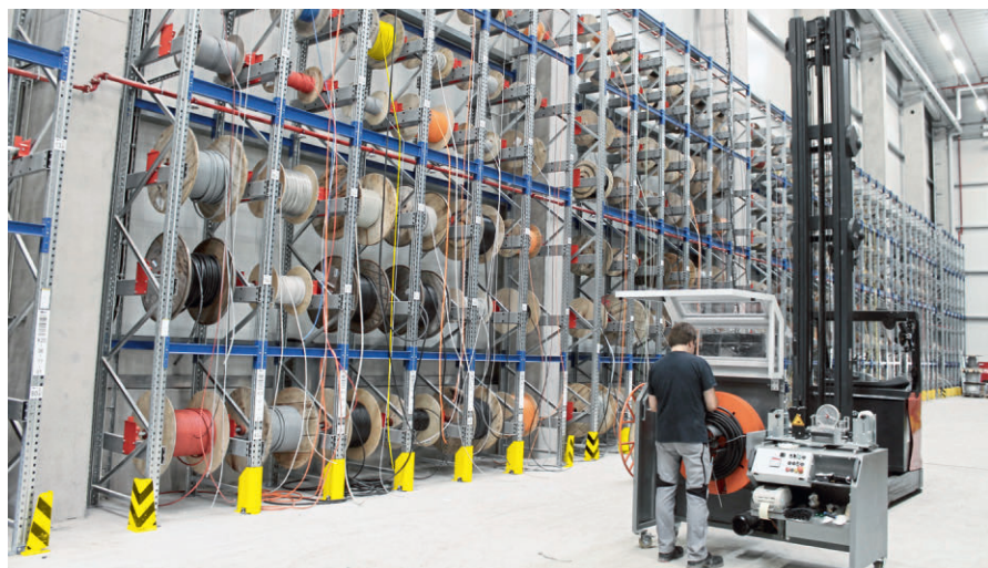
图 4 7m 高的电缆货架系统共有 500 个存放不同电缆的缆盘架口
