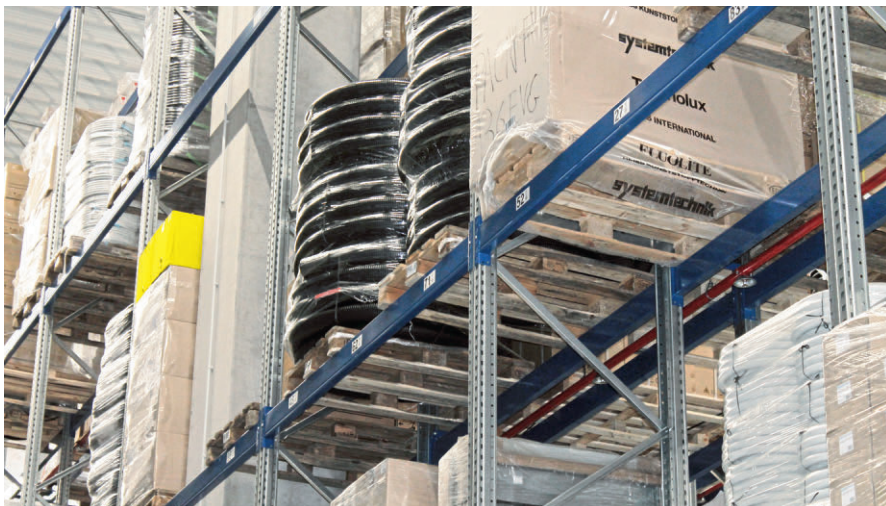
图 5 9 条通道的高架立体库提供了 6500 个托盘架口，并可使用手推式的电动叉车存取物资
