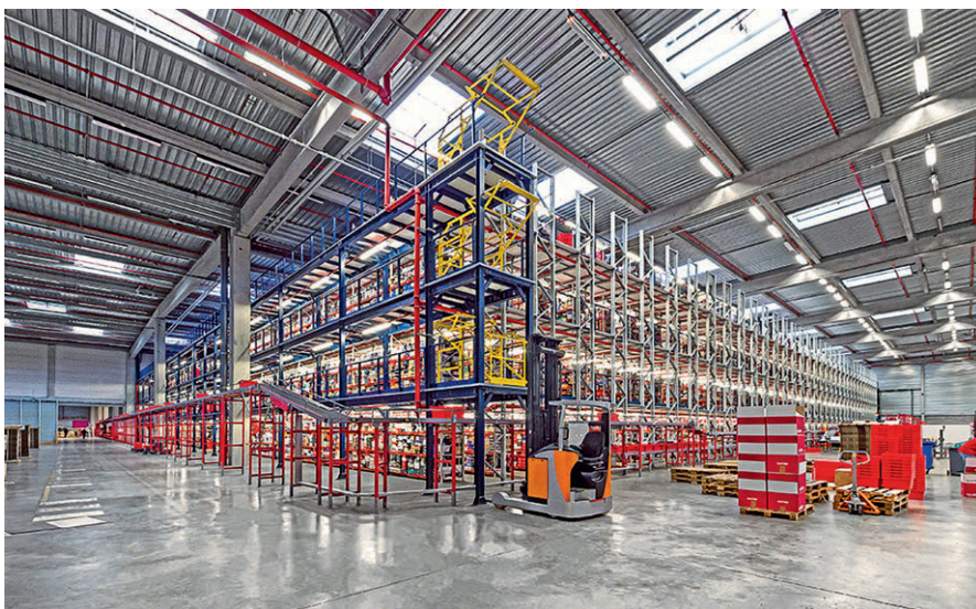
图 3 Mecalux 公司的用户有许多选项可以实现在阁楼式货架系统中的移动：电梯、滑梯、升降机等
