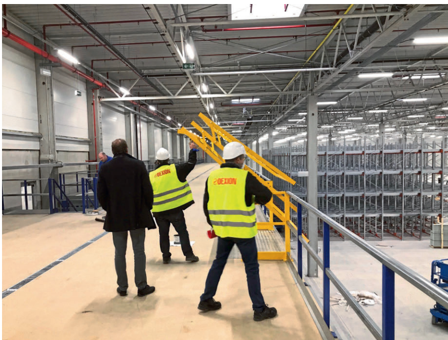
图 1 Dexion 公司设计制造的阁楼式货架系统各层平台和楼梯都设计有符合标准规定的安全护栏。平台地板则根据用户的成本费用要求选择最合适的原材料
