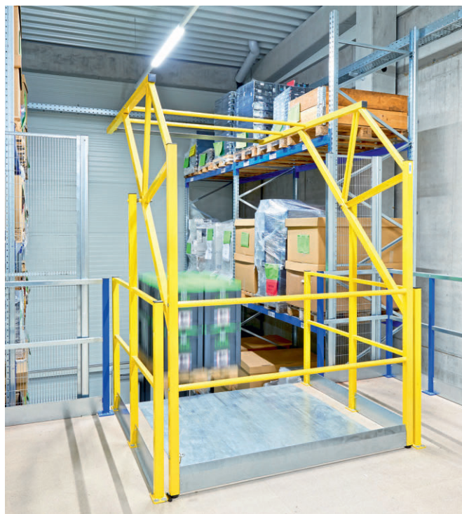
图 4 利用三个托盘中转站可以将物资运送到阁楼式货架系统各层存取物资
