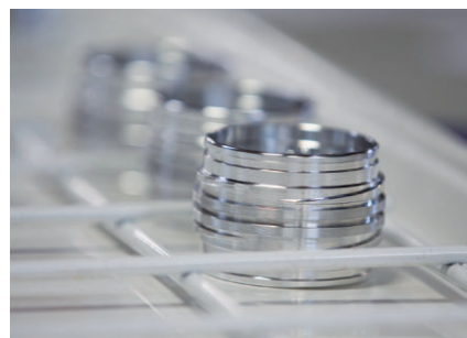
图 2 这种多线程医疗设备零部件需在 CNC 加工中心进行高精度处理，所以需增加第三个班次。根据 Toolcraft 的解决方案，此看护工作交由协作机器人 UR5e 负责
