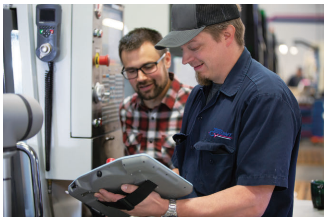
图 1 Toolcraft 的自动化工程师 Brian Laulainen 成功创建了一款零部冲洗和干燥工作站，作为 Universal Robots 协作机器人 UR5e 的应用插件
