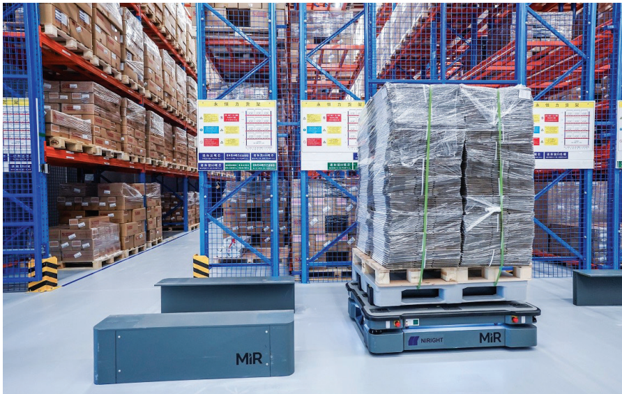
图 2 ICM 部署了 3 个 MiR 1000 自主移动机器人来承担内部运输任务
