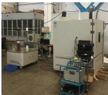
图 1 极寒环境下击穿电压测试试验接线图
