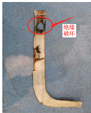
图 7 匝间绝缘纸破坏
