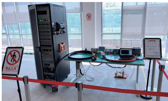
图 6 连接器组件温升试验台 Fig. 6 Temperature rise test platform for cable assembly using adaptor
