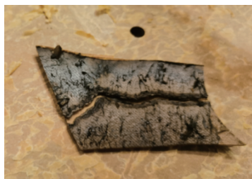
图 3 压板内裂纹放电击穿通道
