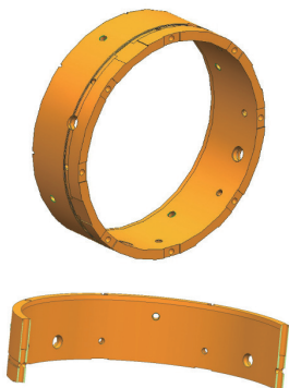
图1 典型薄环壁轴向台阶深孔系结构
