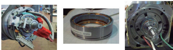
图4 电主轴旋转变压器拆卸
