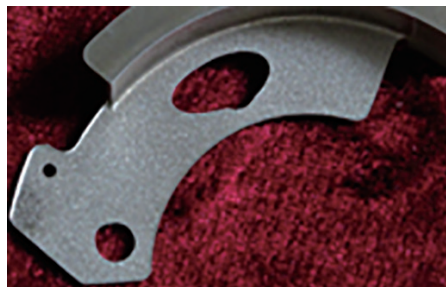
图3 拉簧安装座加工中出现扩孔现象
