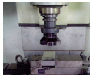
图1 工件刀具装夹
