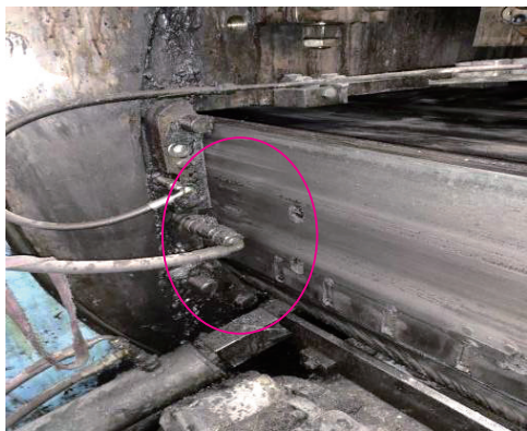
图7 工作台与筒体侧板间隙测量
