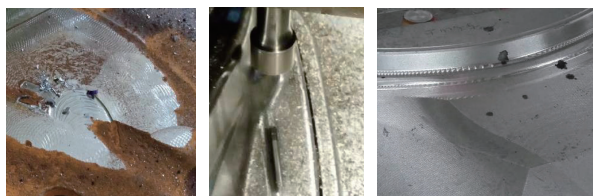
a) 加工过切 b) 刀具破损 c) 表面振纹缺陷
