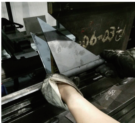
图3 上模加工处理后折弯
