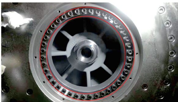
图7 转台制动盘内圈的固定螺栓
