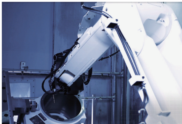
图2 机器人清理工件毛刺
