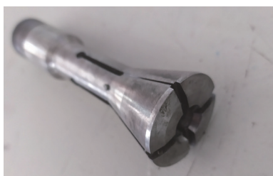
图3 气门车锥面用弹簧夹头
