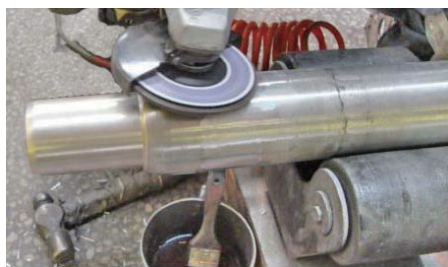
图5 风砂轮打磨情况
