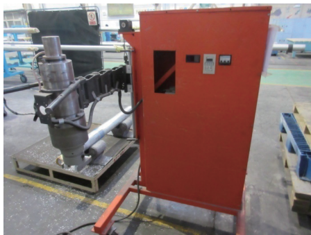
图4 使用焊缝加工装置加工情况
