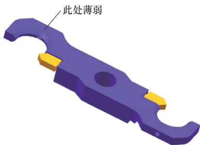
图1 断裂前机械手的回转式换刀臂
