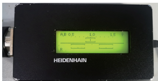
图2 海德汉编码器信号测试
