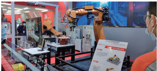
图6 配备3D视觉相机的RB165机器人
