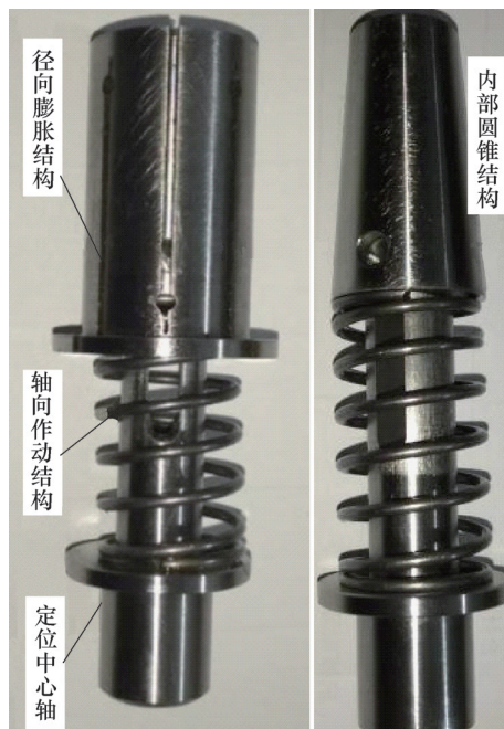
图7 随孔径上下浮动定位结构
