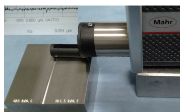
b) \phi 3\text{mm}R1.5\text{mm} 球刀加工后实测表面粗糙度值
