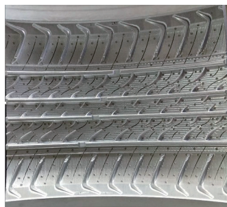
图10 五轴加工完成花纹块
