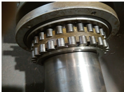
图2 轴承滚柱磨损发黑
