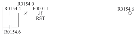
图14 用于自动停机保持的继电器
