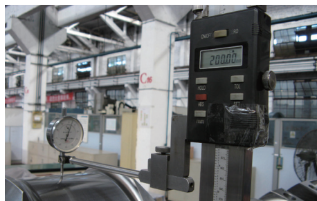
图8 第1连杆颈偏心距偏差值的测量
