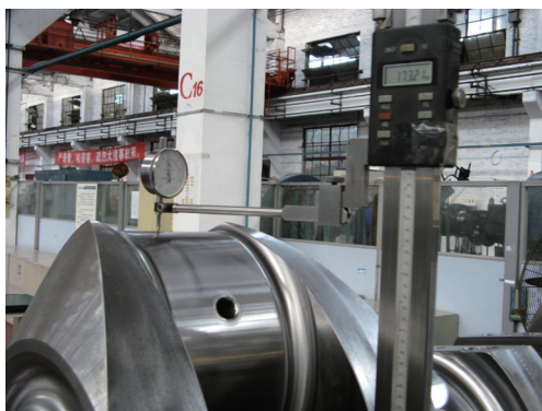
图7 测量第4连杆颈高度偏差值
