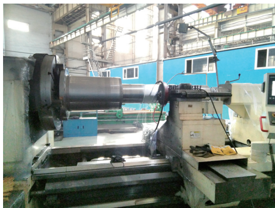
图2 在卧式车床上采取磨削的方式加工油管镀铬层
