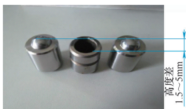
图5 A工位下模与弹力支撑机构
