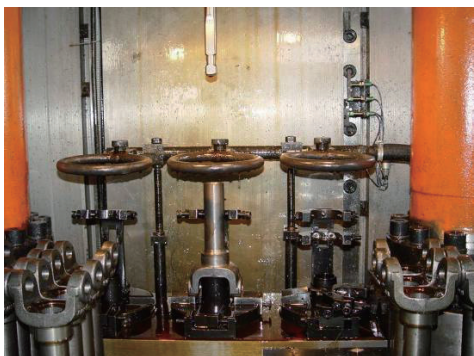
图4 零件用夹具进行定位
