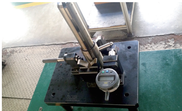
图7 缺齿角度检测专用检具校准
