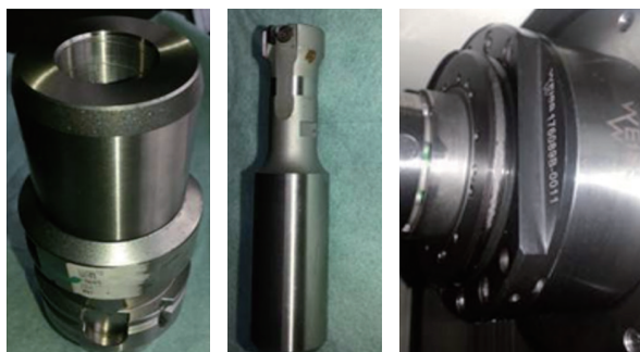
a) 普通液压刀柄跳动公差 6 \mu\text{m} b) 刀具调节公差 2 \mu\text{m} c) 主轴跳动公差 15 \mu\text{m}
