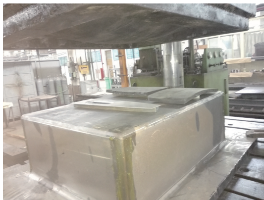
图11 待成型零件固定
