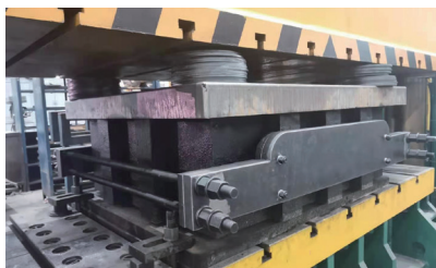
图5 容框在压力机上的安装及固定
