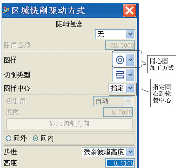
图4 同心圆加工方式
