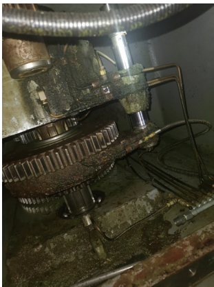
图7 润滑油管路被油泥堵塞
