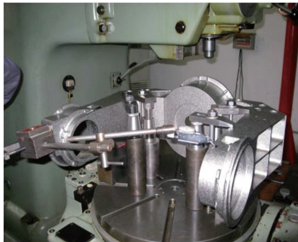
图3 U形相机支架装夹变形实时监测措施
