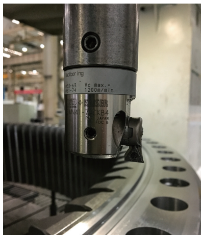
图8 内齿圈销孔的加工
