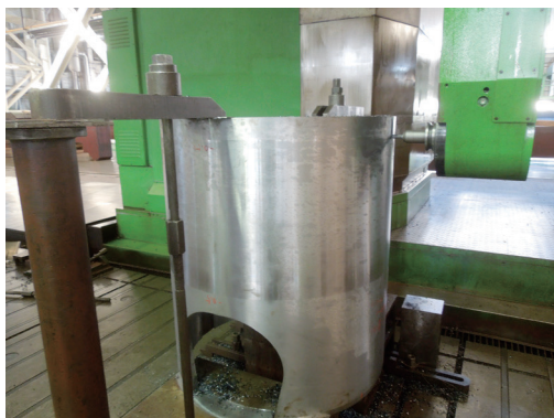
图9 精铣宽 100_{+0.3}^{+0.1} mm通长键槽及 40\text{mm} \times 81\text{mm} 键槽
