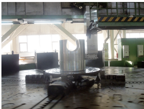
图8 精加工工件内孔及外圆
