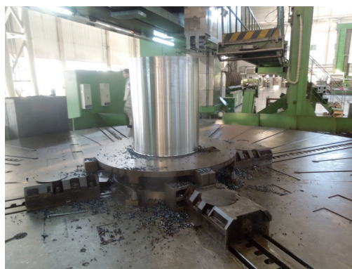
图4 半精加工工件内孔及外圆
