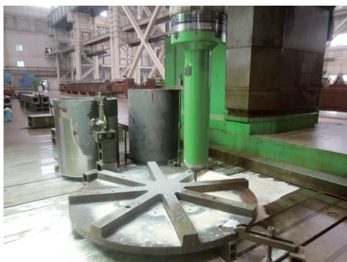
图2 在现有工装垫板上加工通孔及销孔
