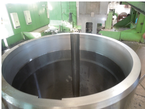
图6 铣宽 100_{+0.3}^{+0.1} mm通长键槽及 40\text{mm} \times 81\text{mm} 键槽
