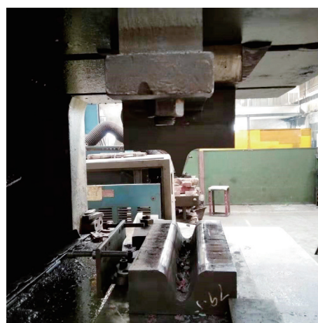
图3 模具现场装配情况
