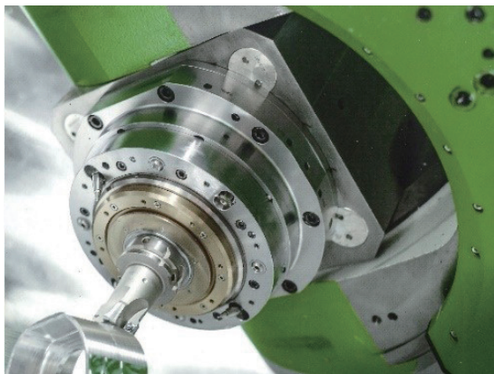
图3 SPM型立铣刀铣削薄壁壳体零件
