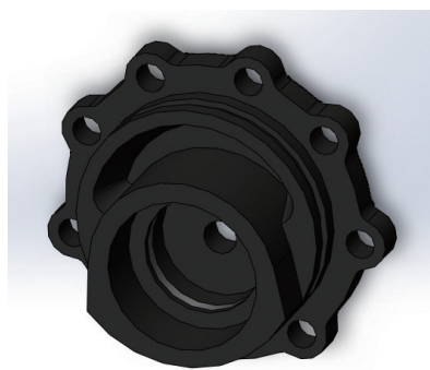
图1 偏心盖类零件结构示意图
