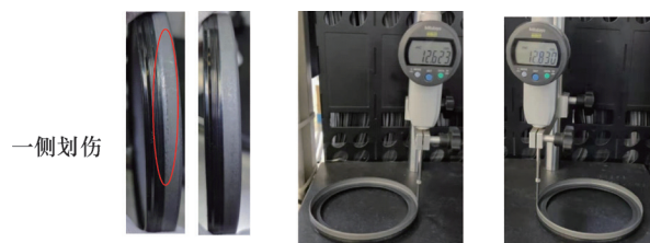
图2 骨架表面一侧划伤且产品整圈的高度存在高度差
