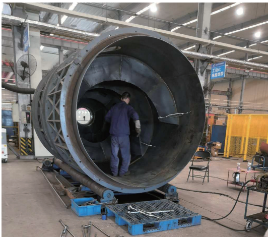
图6 叶片装焊工序改善前
