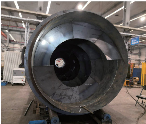
图7 叶片装焊工序改善后
