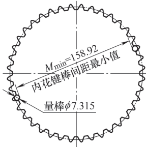
图2 渐开线内花键图样要求
