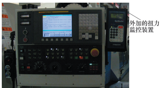
图10 加装扭力监控装置
