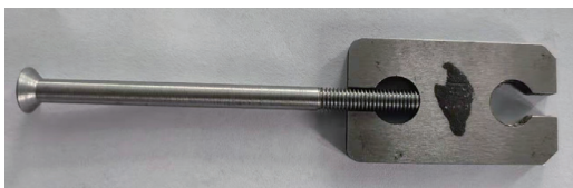
图3 采用专用通、止卡板检测外径
