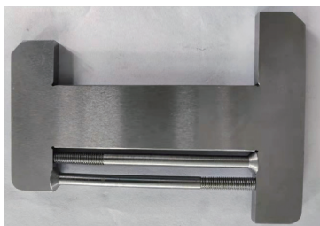
图8 使用专用卡板检测全长
