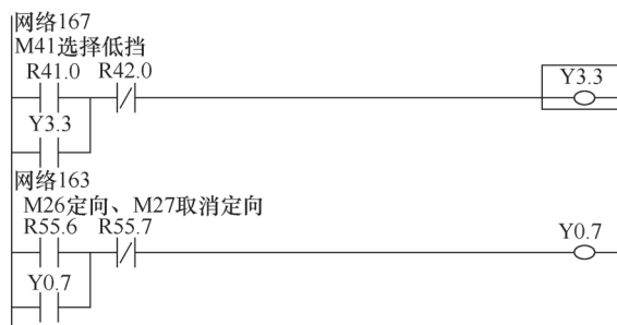
图4 部分PLC程序
